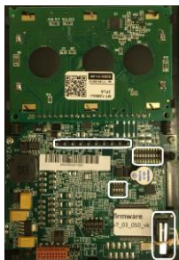
Рисунок 2 – Системная плата пульта SV20G со снятой задней панелью
