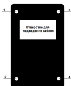
Рисунок 9 – Задняя панель. Монтажные отверстия 1-4
