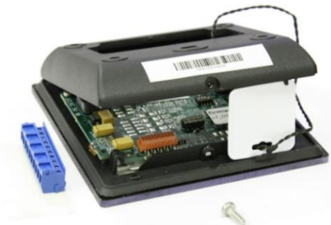
Рисунок 21 – Демонтаж задней (монтажной) панели Считывателя
